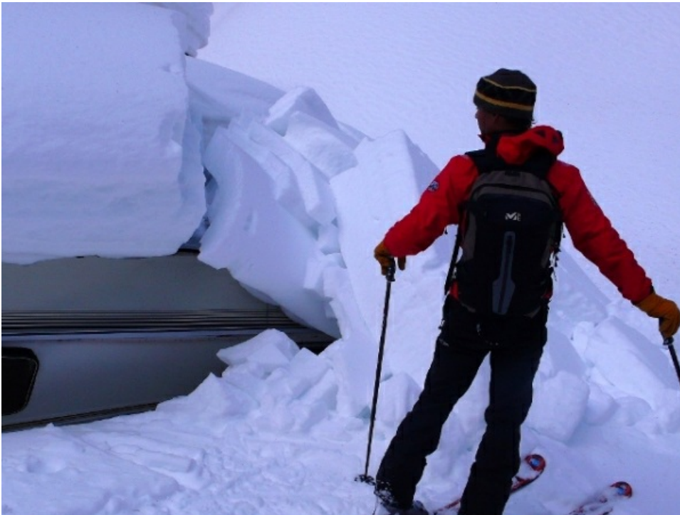
Caravane qui a succomber au poids de la neige, il est intéressant d'observer les différentes couches et points de ruptures (Foto: J.L. Lugon, 04.02.2009, VS).
