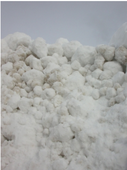
Ablagerung der Fliesslawine: Segregationsschichtung
