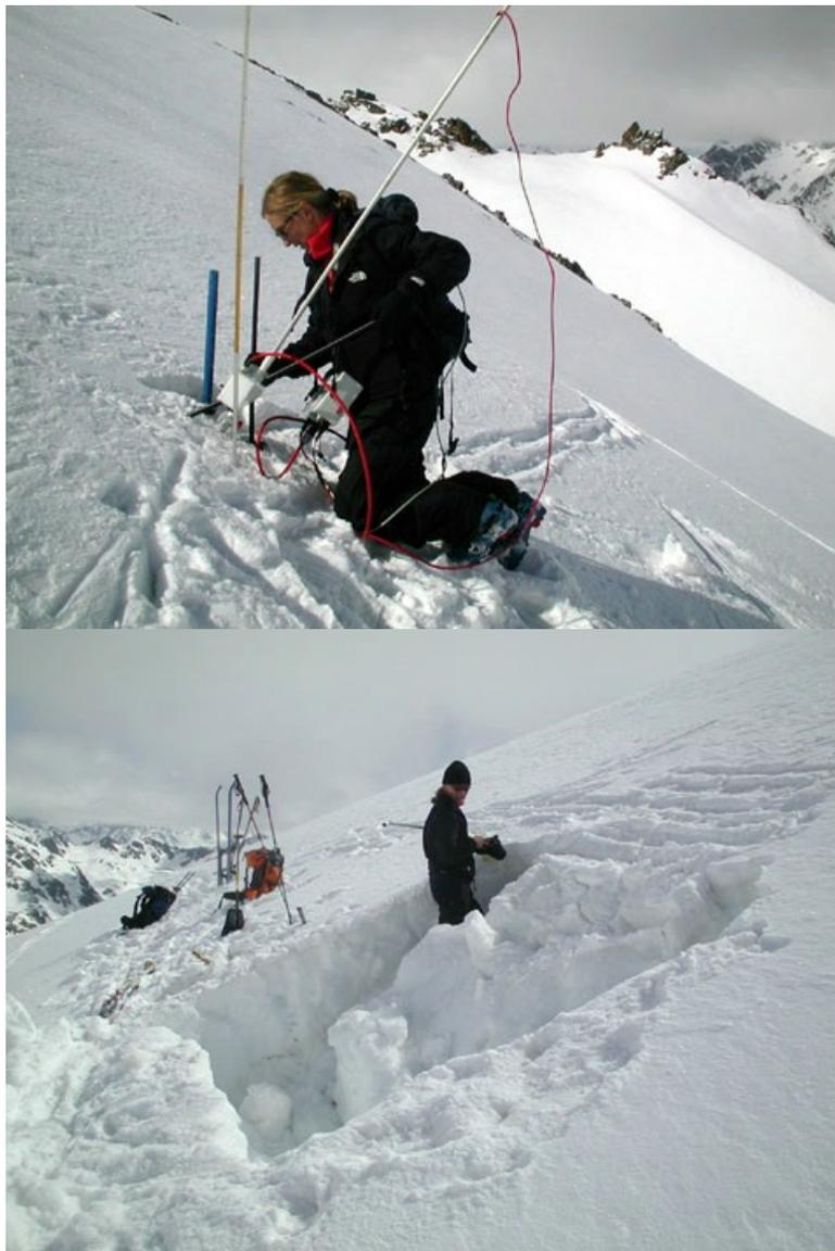
Abb. 6 und 7: Schneedeckeuntersuchung am 15. Mai auf 3000 m. Oben eine sehr exakte Messung der Schneesohrte mit dem SnowMicroPen, unten klassisches Schneeprofil mit (zerst6rtem) Rutschblock. Diese Untersuchungen durch PrognostikerInnen sind im Fr6hjahr Zeit aufw6ndig, aber unbedingt notwendig, weil keine vergleichbaren Informationen mehr zur Verf6gung stehen (Foto: Thomas Wiesinger, SLF / Rad6uner Rothorn, GR).
